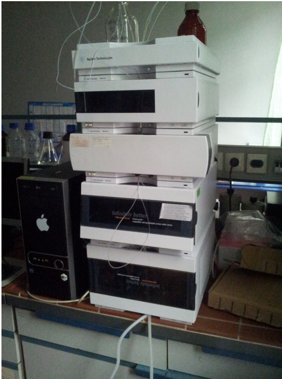
სურათი 3: Agilent 1290 სერიის ზე-მაღალი ეფექტურობის სითხური ქრომატოგრაფი (U-HPLC)
