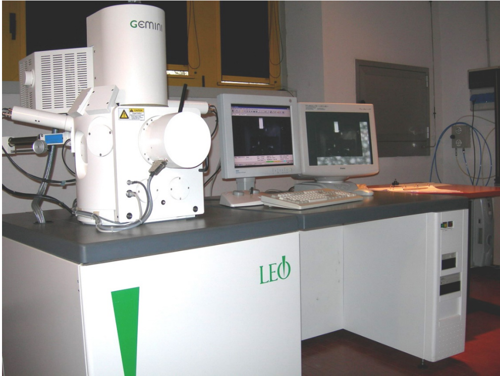
სურათი 6. Zeiss წარმოების ელექტრონული მიკროსკოპი Gemini გარჩევადობა 1.0 ნმ-დან, Gemini სვეტი და ESD დეტექტორით.
