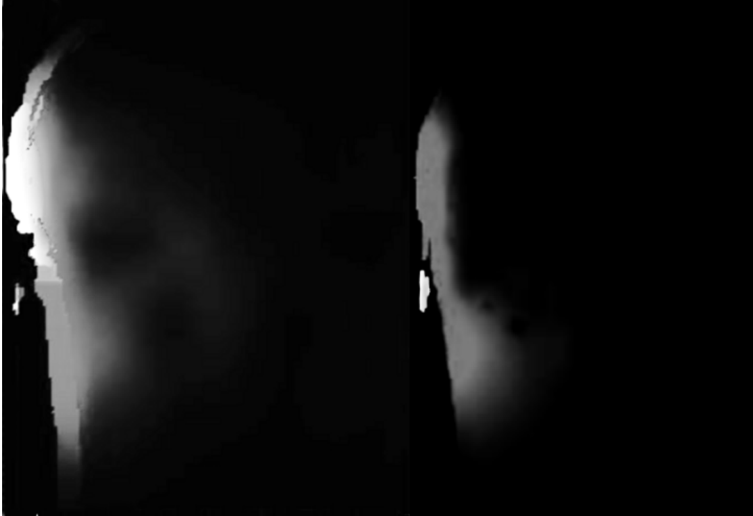
სურ. 4.3.6. ადგილმდებარეობა ა) 10\text{ გ SAR} = 6.7\text{ w/kg} ბ) ტემპერატურის მატება \Delta T = 0.36^\circ\text{C} of \lambda/8 დიპოლური ანტენისათვის 300 მჰც, 10 მმ მანძილზე.
