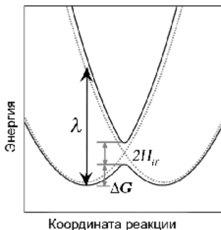
Рисунок 8. Схематическая иллюстрация физических параметров, определяющих термически активированный перенос электрона при \Delta G_o = 0 между редокс-молекулой и электродом [3].
