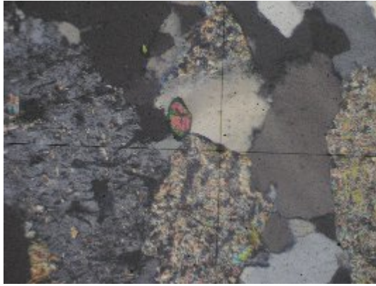
სურ. 19. ცირკონი ბიოტიტ-კორდიერიტიან პლაგიოგნეისებში (ჯვარედინი ნიკ.)
