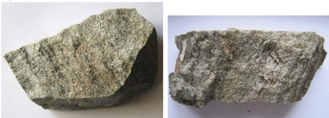
სურ. 8. ბიოტიტ-კორდიერიტიანი პლაგიოგნეისი ზოლებრივი ტექსტურით (მდ. ხრამის ხეობა)
